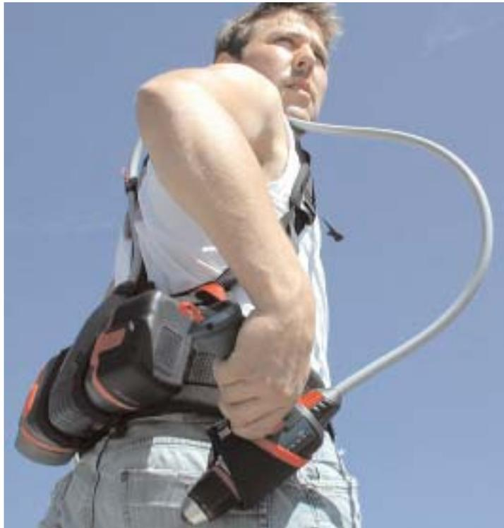
**Das MF Pro System soll den Alltag des Bauarbeiters erleichtern und Kosten senken. Die Grundidee besteht im modularen Aufbau durch örtliche Trennung von Antrieb und Werkzeug.**
